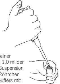
Geben Sie mit einer sterilen Pipette 1,0 ml der hydratisierten Suspension in das 9,0-ml-Röhrchen des Phosphatpuffers mit einem pH-Wert von 7,2.
