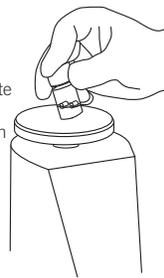
Durchmischen Sie das hydratisierte Material sofort nach der Inkubation mit einem Vortex-Gerät, bis sich die Pellets vollständig gelöst haben und eine homogene Suspension entstanden ist.
